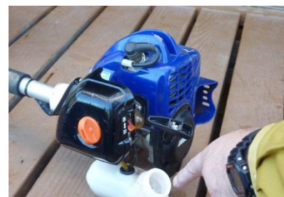
給油口から燃料を注入する。 (タンクの上端レベル以上に入れすぎないこと)
