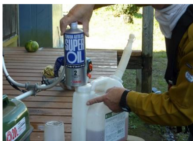
ガソリンとオイルを 50:1 (大きなタンクが目盛が2のときは小さなタンクが目盛も2になる)で混合
