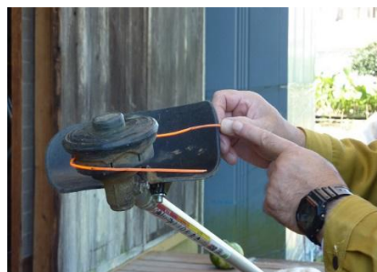
コードの長さは飛散防護カバーから出ないようにする。(長い場合はカップを回して調整する)
